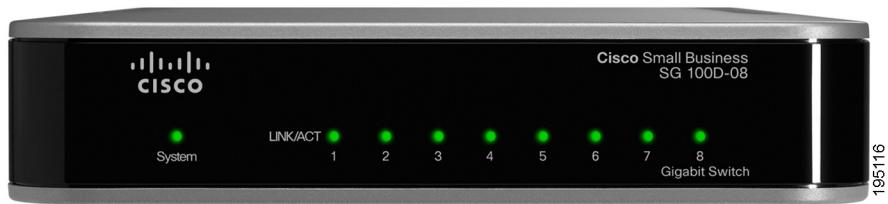
**Indicadores LED del sistema (verdes):** estos indicadores LED se encienden y permanecen encendidos cuando el switch recibe energía. Cuando los indicadores LED están apagados, no hay nada conectado al puerto. O bien, hay un dispositivo conectado al puerto, pero hay algún problema con el cable o el dispositivo conectado.
