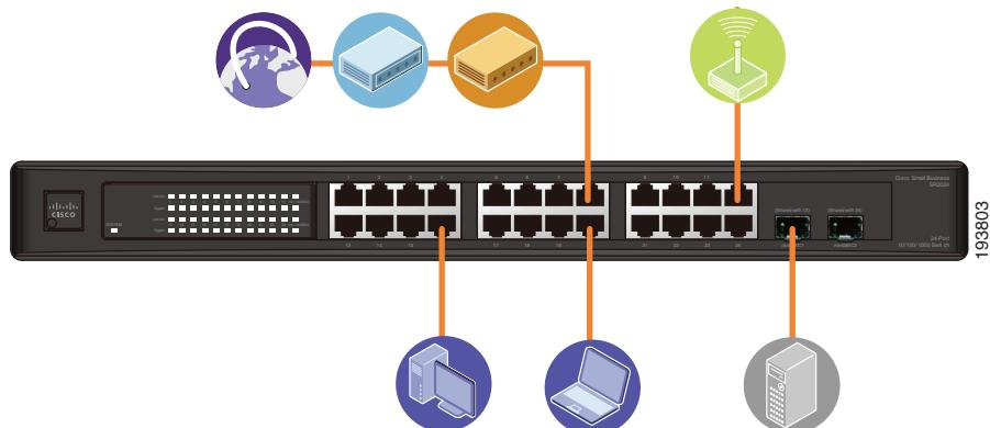
Per collegare i dispositivi di rete (come gateway o altri switch) al proprio Desktop Switch non gestito è necessario un cavo Twisted Pair (TP) idoneo per ogni unità. Per le connessioni Gigabit si consiglia il cavo di categoria 5 o di qualità superiore.
