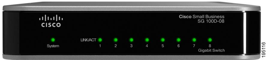
**LED di sistema** (di colore verde): questo LED si accende e rimane acceso quando lo switch è alimentato. Quando il LED è disattivato, nessun dispositivo è collegato alla porta. In alternativa, c'è un dispositivo collegato alla porta ma c'è un problema con il cavo o con il dispositivo collegato.
