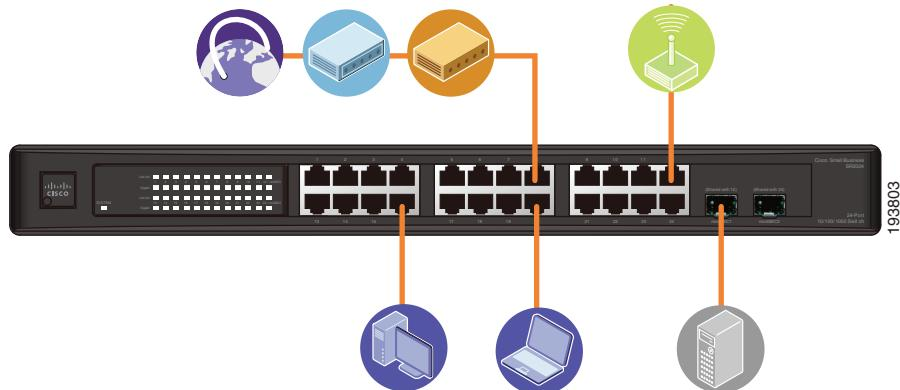
**Pour connecter les appareils de réseautique** (tels que des passerelles ou des Commutateurs) à votre Commutateur de bureau non géré vous avez besoin d'un câble à paire torsadée approprié pour chaque unité. Nous vous recommandons d'utiliser un câble de catégorie 5 ou supérieure pour les connexions Gigabit.
