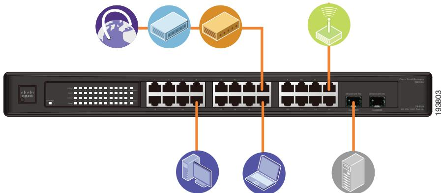
Para conectar **dispositivos de red** (como gateways u otros switches) al switch de escritorio no administrado, necesita un cable de par trenzado (TP) para cada unidad. Recomendamos un cable de categoría 5 o superior para conexiones Gigabit.
